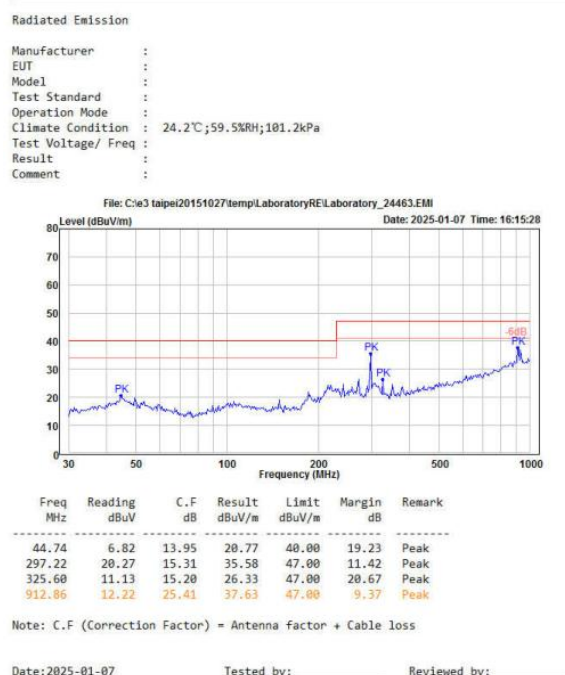
图 5-6 辐射测试水平方向
