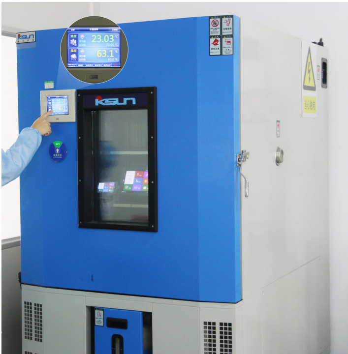
图 5-3 高低温老化测试图
