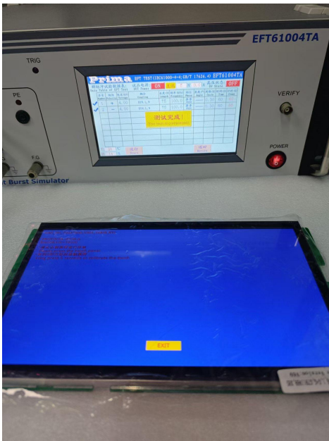
图 5-4 群脉冲测试图
